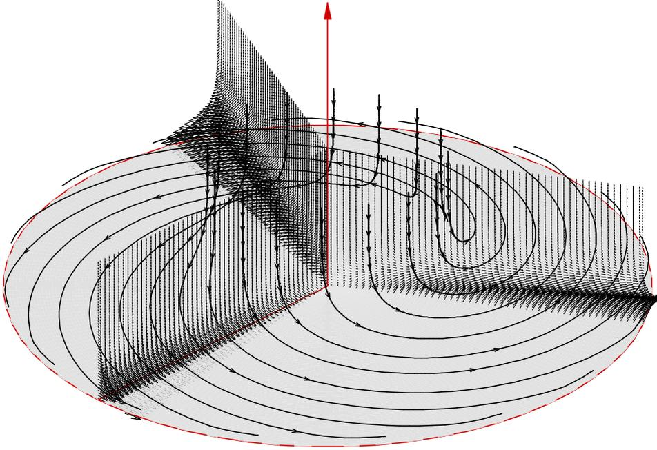
回転円板の壁面から十分に離れた領域では、粘性の影響はなく、円板に向かう一様な流れと見なされる。今、 $u, v, w$  はそれぞれ、半径方向、周方向、軸方向の速度成分とする。軸対称流れを仮定した円筒座標系の Navier-Stokes の運動方程式は、以下のように与えられる。
