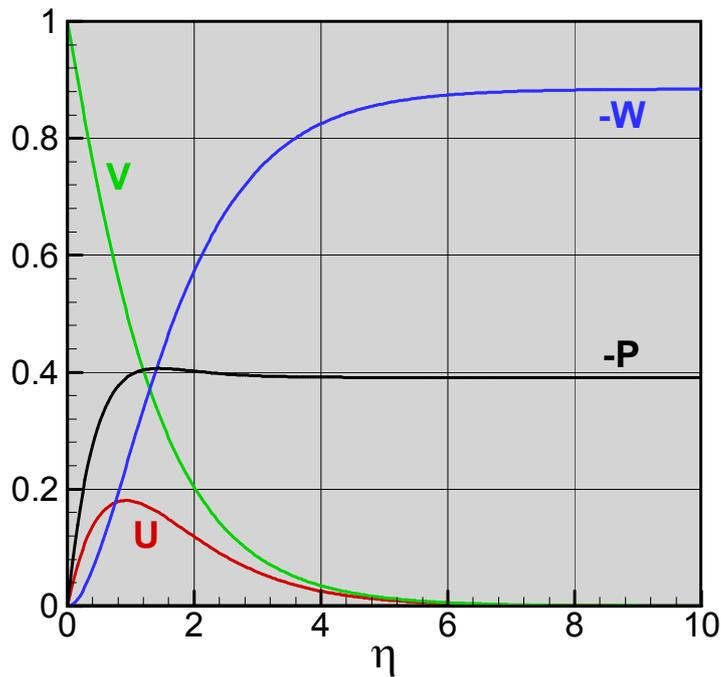
図 1 回転円板による流れの計算結果 ( $W$  と  $P$  は負号を付けて表示)
