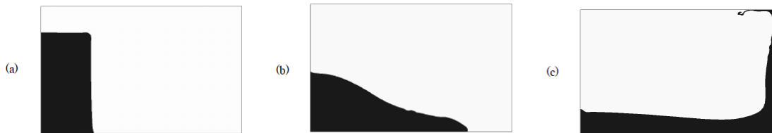
図2.4 水柱の崩壊の様子 ( G = 4.79 \times 10^6 , \Gamma = 1.17 \times 10^7 , 密度比 = 800, 粘度比 = 50) (a) \tau = 0.0001 , (b) \tau = 0.0008 , (c) \tau = 0.0016 8)
