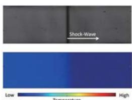
シミュレーション法と感温塗料計測法による衝撃波の可視化
