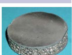
発泡アルミニウムを用いたサンド・イッチ・パネル
